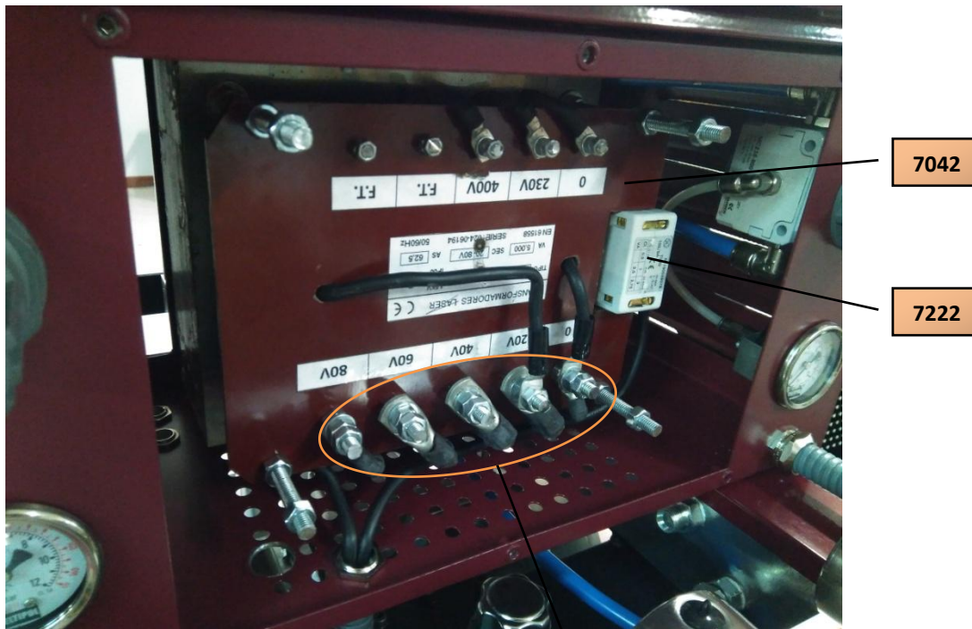
Exemplo de conexão de transformador 5000VA
